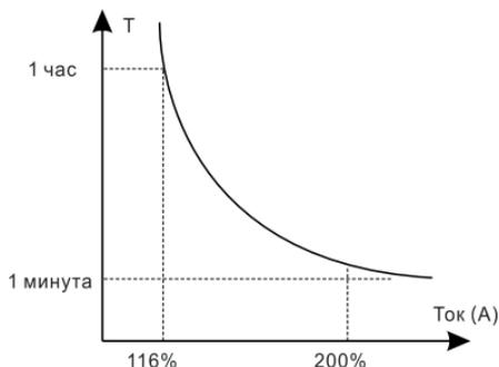
Рис.6.5 Кривая зависимости тока перегрузки от времени
