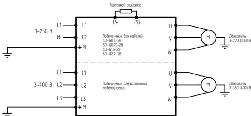
Рис. 3.2. Схема силовых подключений
