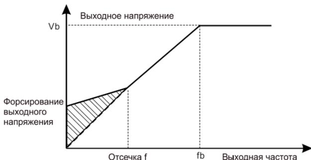
Рис.6.7 Повышение крутящего момента электродвигателя
