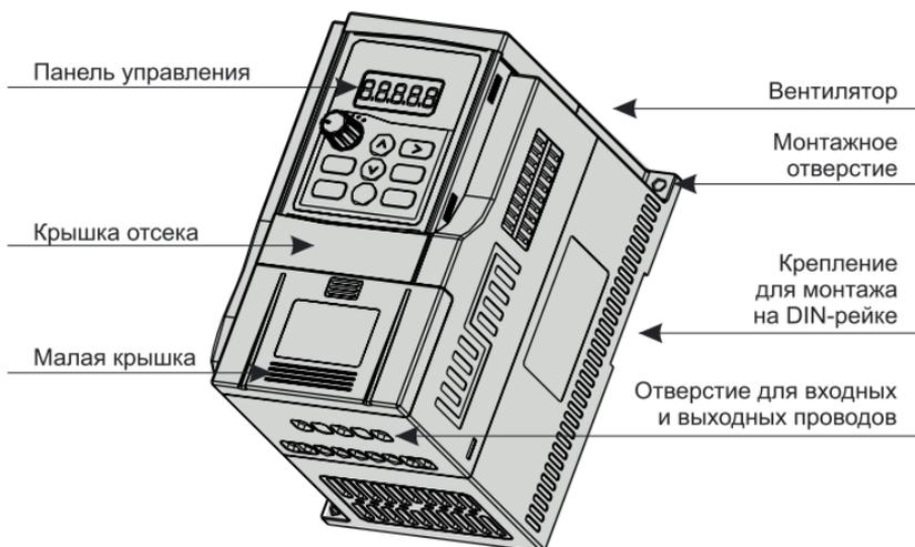
Рис.2.3 Схема модели серии SDI
