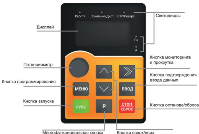
Рис. 5.1. Функции кнопок и светодиодов панели управления SDI
