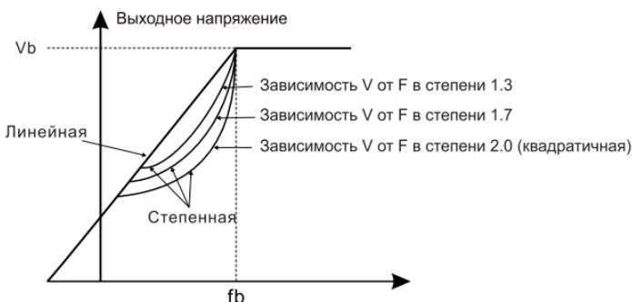
Рис. 6.6 Типы характеристик для электродвигателя
