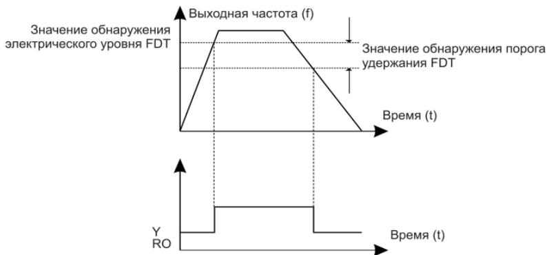
Рис. 6.13. Значения обнаружения выходной частоты
