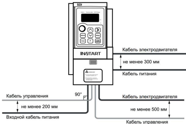
Рис. 3.6 Графическое представление расстояний между кабелями
