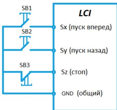
Кнопка SB3 (H3) является подтверждающей запуск клеммой, кнопка SB1 – запуск в прямом направлении, SB2 – запуск в обратном направлении.
