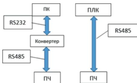
Рис. 7.1 Сетевой режим Master/Slave
