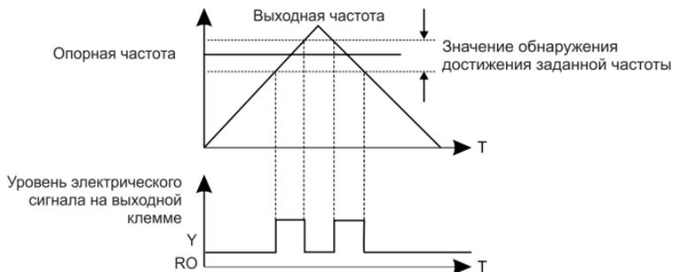
Рис. 6.14. Диапазон достижения максимальной частоты
