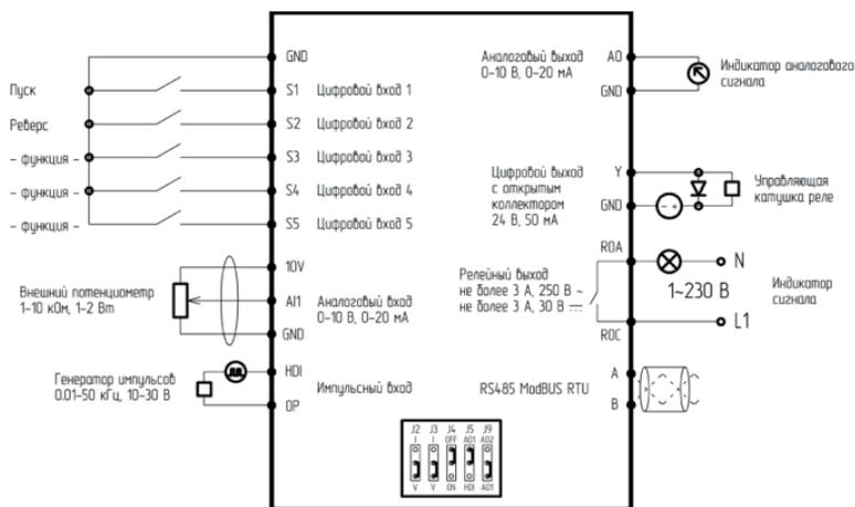
Рис. 3.4 – Схема подключения управляющих клемм
