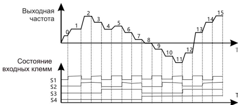
Рис. 6.24. Многоступенчатое управление
