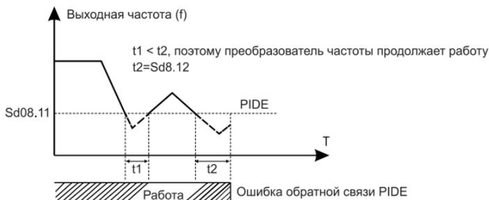
Рис. 6.16. Обнаружение отсутствия сигнала обратной связи
