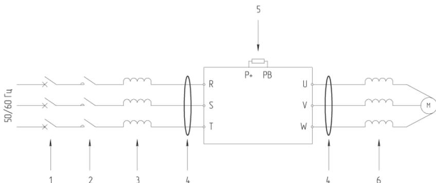
Рис. 3.3 – Схема подключения дополнительного оборудования
