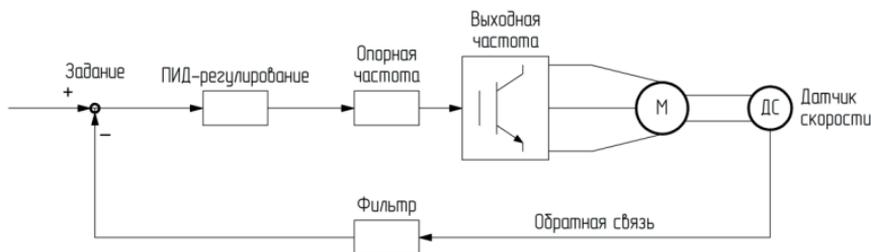
Рис. 6.15 Схема ПИД-регулирования
