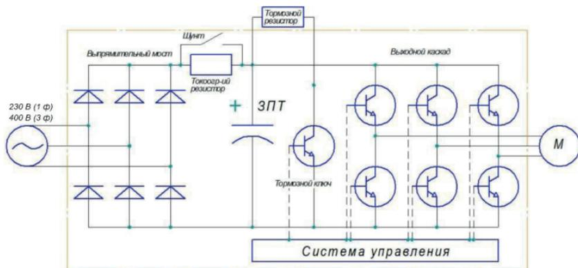
Рис.2.1. Принципиальная электрическая схема ПЧ
