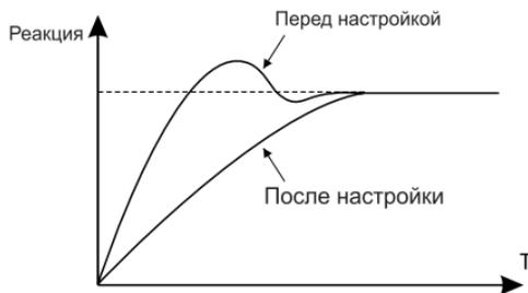
Рис.6.19 Управление перегуливанием
