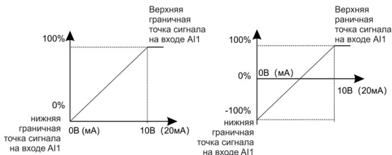
Рис.6.10 Графики сигналов, подаваемых на AI1
