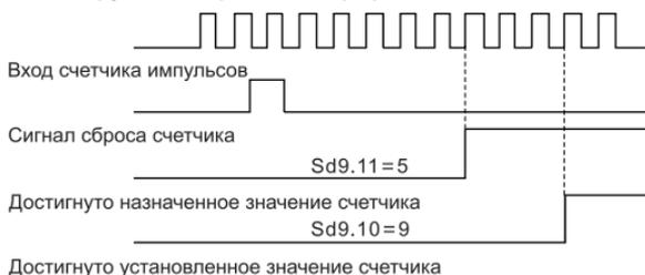
Рис. 6.23. Работа функции счетчика импульсов
