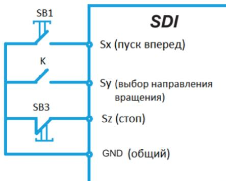
Кнопка SB3 (H3) — является подтверждающей запуск клеммой, кнопка SB1 — подтверждающей запуск, переключатель К определяет направление вращения.
