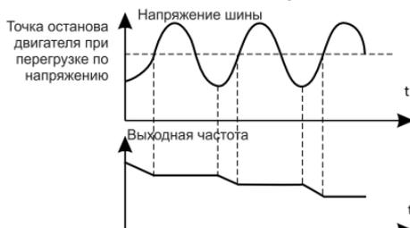
Рис. 6.25 Защита при превышении напряжения
